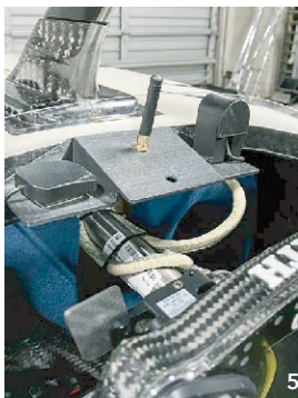
富士スピードウェイにおける実証の様子。時速290キロでの低遅延伝送、時速270キロという高速走行域でのハンドオーバーに成功。 4. 開発テスト車両「赤寅」の走行中の様子（運転席のすぐ前にアンテナとカメラを設置） 5. 開発テスト車両「白寅」に搭載されたローカル 5G のアンテナ（左）と伝送端末（右）
