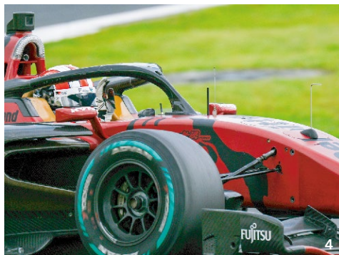
富士スピードウェイにおける実証の様子。時速290キロでの低遅延伝送、時速270キロという高速走行域でのハンドオーバーに成功。 4. 開発テスト車両「赤寅」の走行中の様子（運転席のすぐ前にアンテナとカメラを設置） 5. 開発テスト車両「白寅」に搭載されたローカル 5G のアンテナ（左）と伝送端末（右）
