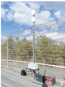
2025年1月、もてぎで行なわれたスポーツカーベースの車両を用いた先行実証。時速200キロでの低遅延伝送と、時速150キロでのハンドオーバーに成功。 1. 走行中の様子 2. ローカル 5G 基地局 3. 車両の前席シートバックに伝送端末を装着
