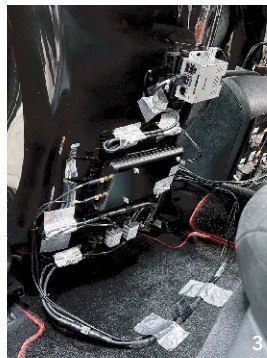
2025年1月、もてぎで行なわれたスポーツカーベースの車両を用いた先行実証。時速200キロでの低遅延伝送と、時速150キロでのハンドオーバーに成功。 1. 走行中の様子 2. ローカル 5G 基地局 3. 車両の前席シートバックに伝送端末を装着
