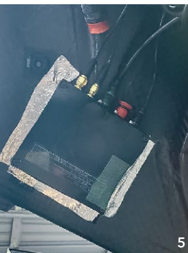
富士スピードウェイにおける実証の様子。時速290キロでの低遅延伝送、時速270キロという高速走行域でのハンドオーバーに成功。 4. 開発テスト車両「赤寅」の走行中の様子（運転席のすぐ前にアンテナとカメラを設置） 5. 開発テスト車両「白寅」に搭載されたローカル 5G のアンテナ（左）と伝送端末（右）
