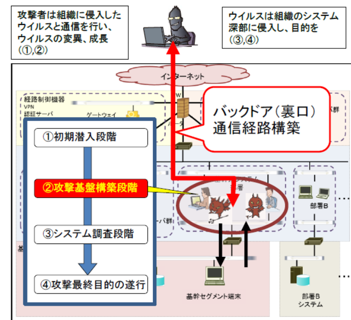
図 3-1-2: 検知をすり抜け、素早く次のステップ(攻撃基盤構築)に移行するイメージ
